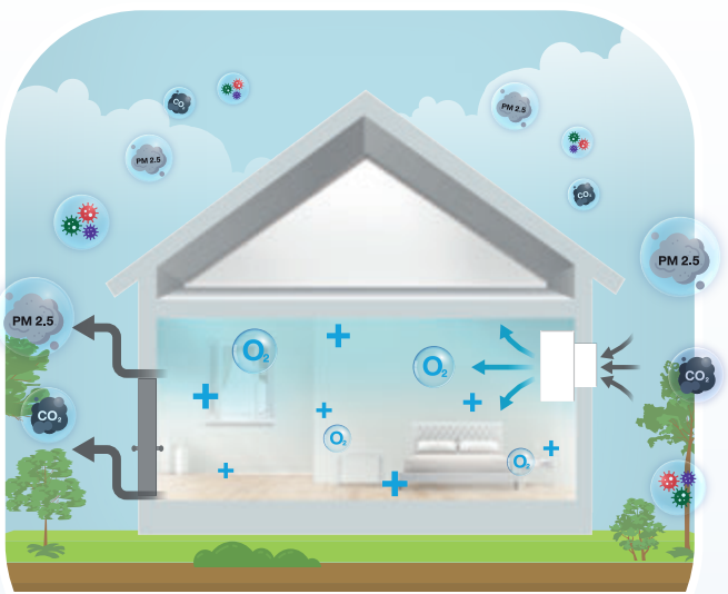
อากาศภายในห้องมี แรงดันเป็นบวก จะดันอากาศภายในออกจากห้องตามช่องว่างต่างๆ ตลอดเวลา
